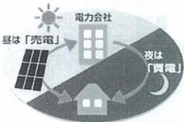
力会社から電気を買うことになり。日射量で発電量が変わってくるため、曇り・雨・雪の日には発電量が落ちます。
